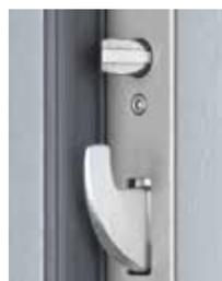
So macht die eingebaute Mehrfachverriegelung mit ihren Schwenkriegeln und Rundbolzen in Verbindung mit einer massiven Schließleiste ein Auseinanderdrücken von Türflügel und Blendrahmen nahezu unmöglich. Zudem ist der Hauptschlossriegel gegen Aufsagen gesichert und lässt sich nicht mit einer Scheckkarte zurückdrücken. Abgerundet wird
