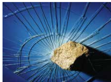
P4A-Sicherheitsglas. Die Scheibe hält selbst Wurfgeschossen stand.
